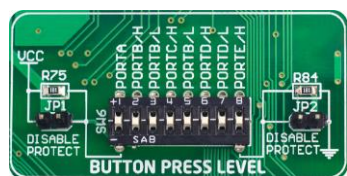
Рисунок 5.1 – трехпозиционный DIP переключатель выбора логического уровня при нажатии кнопки
