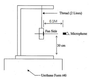
0.1 METER FROM MICROPHONE TO FAN INTAKE
