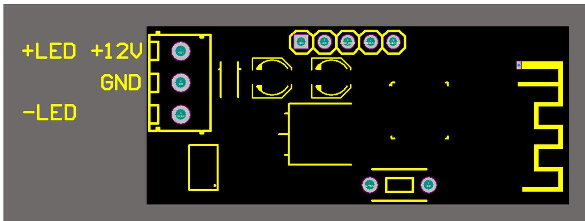
Рисунок2. Подключение модуля, назначение контактных зажимов
